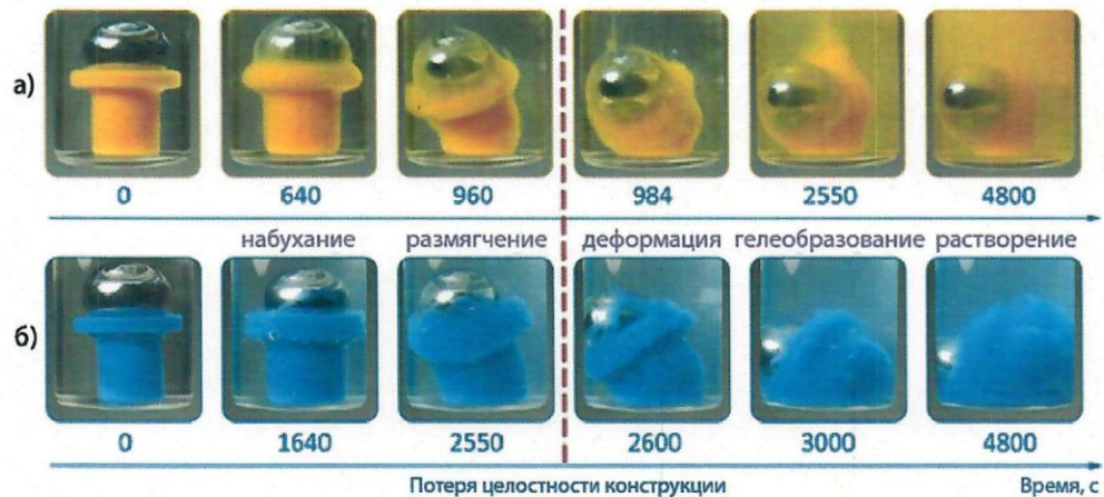
Рисунок 10. Фотографии эксперимента по определению устойчивости изделия, созданного методом послойного наплавления, к растворителю.
